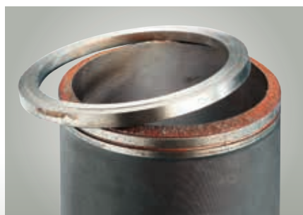
Abb. 1: Abgerissener Bund der Zylinderlaufbuchse
