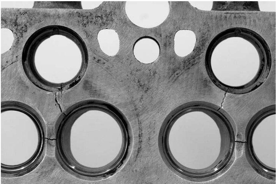
Bild 6.13 Risse an Ventilsteg und Brennkammer eines Pkw-Wirbelkammermotors
