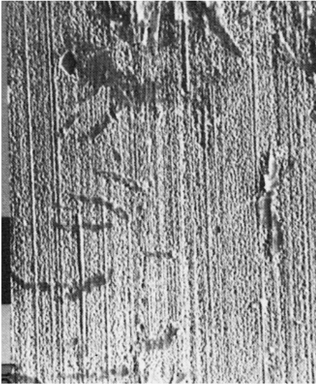
Bild 6.314 Korrosiver Verschleiß [Quelle: MTZ]
