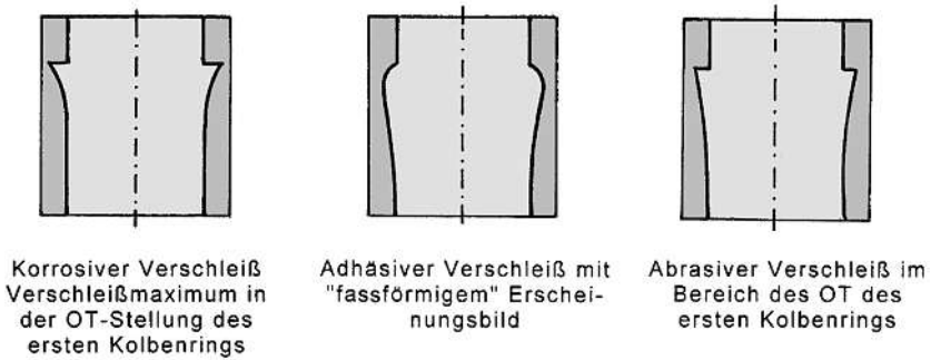
Bild 6.313 Der Zylinderverschleiß größerer und großer Dieselmotoren setzt sich aus mehreren Anteilen zusammen.
