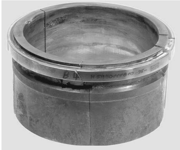
Bild 6.330 Gereinigte Zylinderlauf- buchse mit nachträglich zur Befundung aufgebrochenen Rissen
