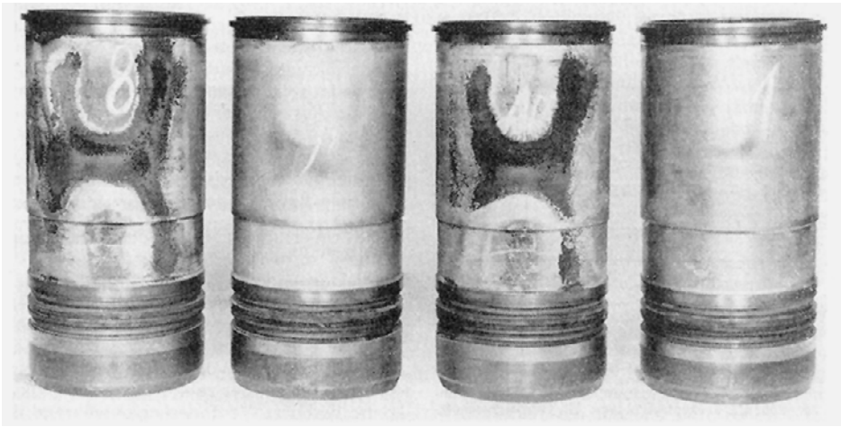
Bild 6.327 Zylinderbuchsen mit Kavitationserscheinungen
