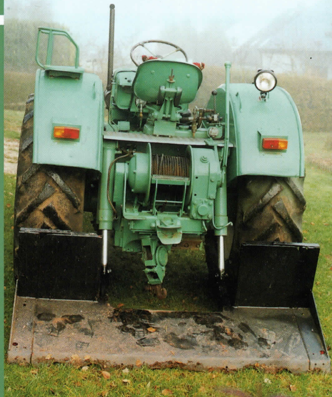
▲ Seilwinde FWS von Schlang & Reichardt mit hydraulischer Bergstütze.
